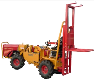
Hubmast Hubkraft 200 kg Hubhöhe 1,20 Meter
