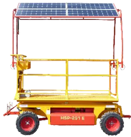
Dach mit Sonnenkollektoren Für zusätzliche Ladekapazität
