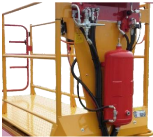
Kompressor Kapazität: 250 ltr/min – 11 bar
